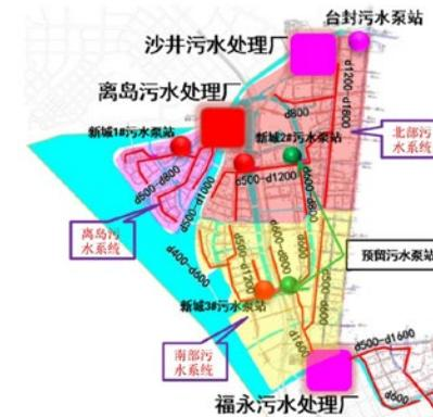
污水系统分区管网收集示意图
